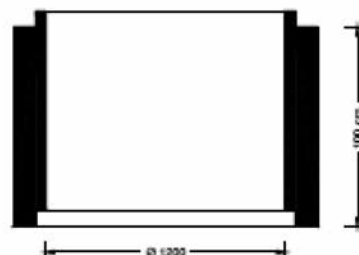
Anillo de pozo Peso por unidad: 800 kgs. Espesor: 160
